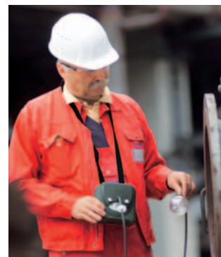
Dräger X-am 7000: Eine integrierte Hochleistungspumpe vereinfacht Freigabemessungen.
